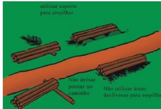
Figura 8 - Empilhamento de toras de madeira. Detalhes dos tipos de suporte para aeração da madeira empilhada e recomendações para evitar acidentes.
