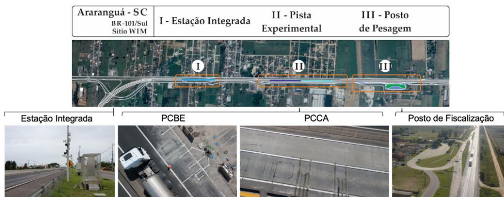
Figura 3 – Sítio de Pesquisa de HS-WIM de Araranguá/SC e seus componentes
