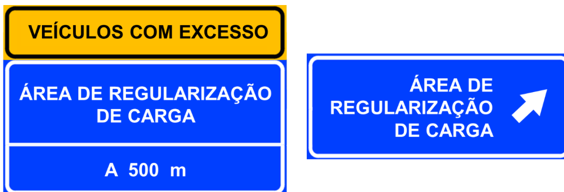
Figura 8 – Orientação ao condutor em locais com área de regularização de carga nas imediações do sistema HS-WIM
