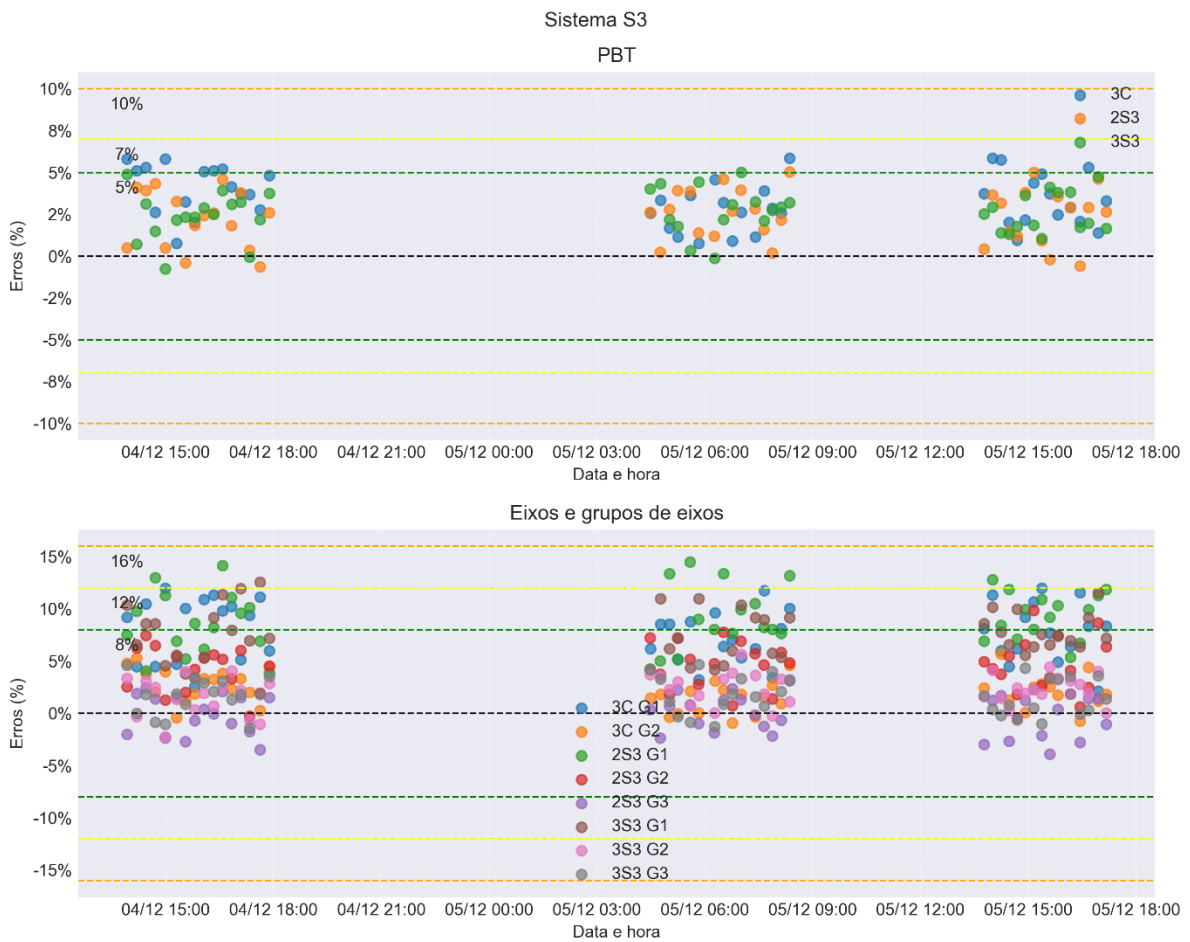
Figura 44 – Dispersão de erros em função do horário da coleta para o sistema S3
