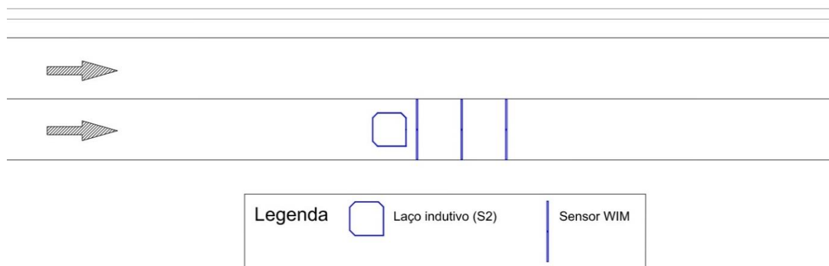
Figura 10 – Estrutura do sistema S4
