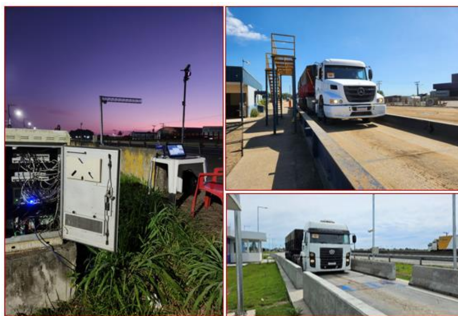
Figura 7 – Processo de calibração dos sistemas de pesagem em movimento (fev. de 2023)
