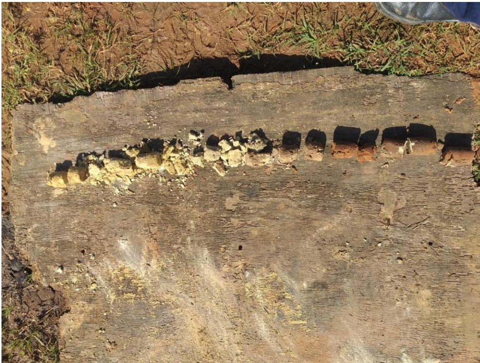
Foto 4. Material arenoso amostrado como resultado do método SPT.
