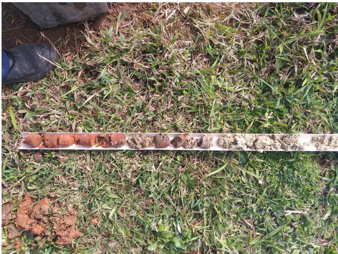
Foto 6: Mudança rápida de camadas com texturas diferentes (argilosa para arenosa) em um mesmo amostrador.
