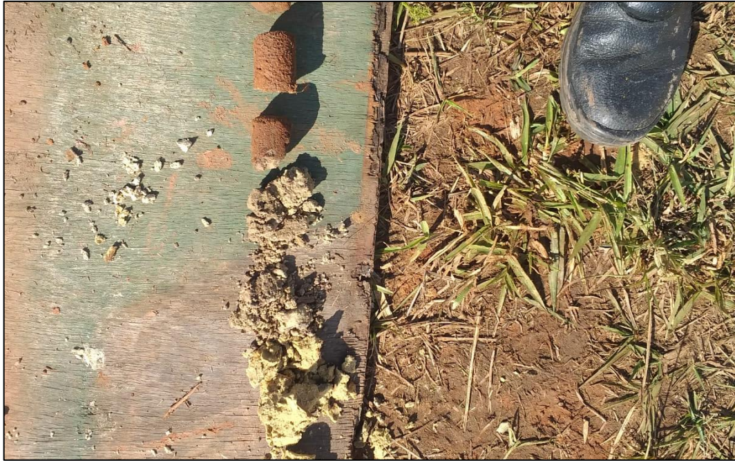
Foto 5. Exemplo de material arenoso coletado no amostrador durante a realização das sondagens.
