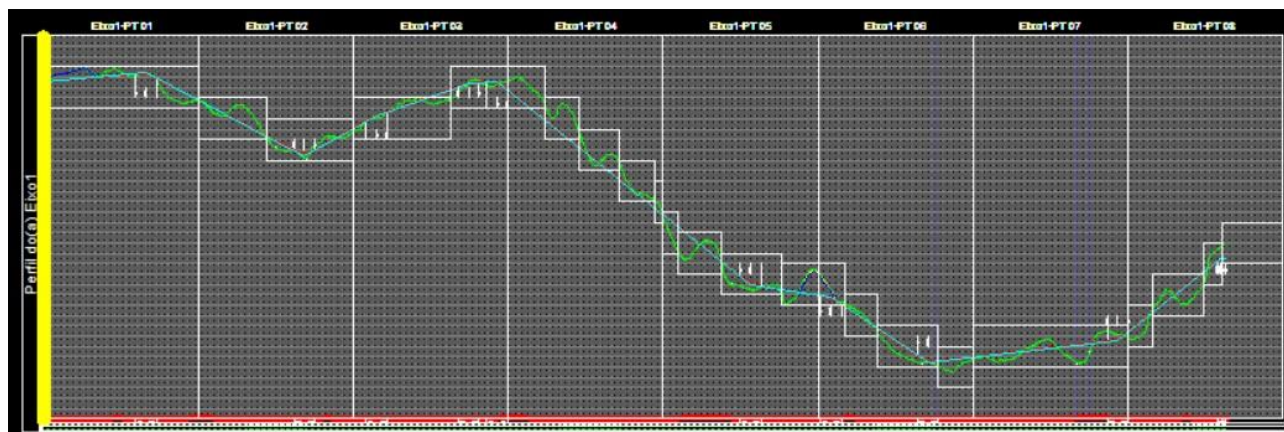
Figura 33: Greide e projeto altimétrico - Representação.
