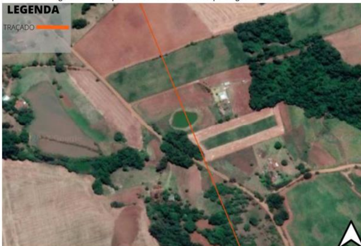
Figura 23 - Exemplo de interferência com corpo d'água e via existente.
