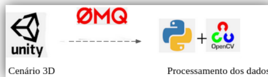
Figura 42 - Transmissão de dados da simulação 3D para códigos externos, utilizando ZeroMQ.
