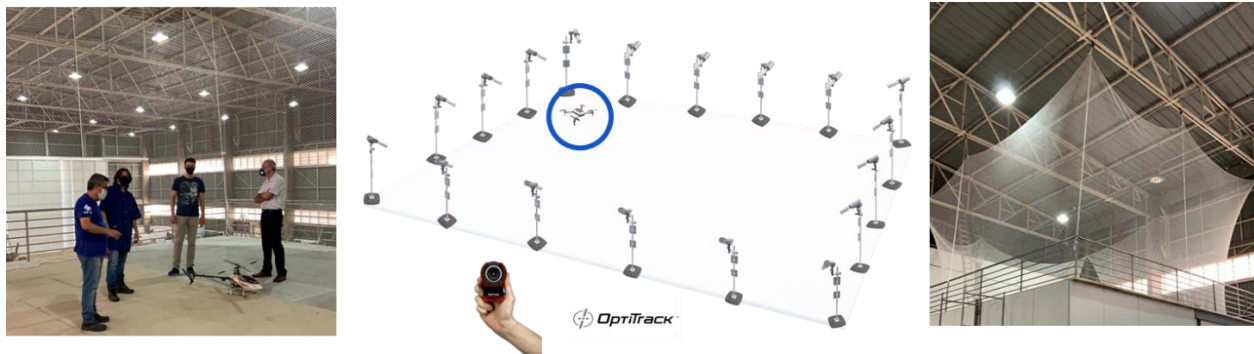
Figura 39 – Arena de drones destinada a realização voos experimentais indoor e dotada de múltiplas câmeras de OptiTrak de rastreamento.
