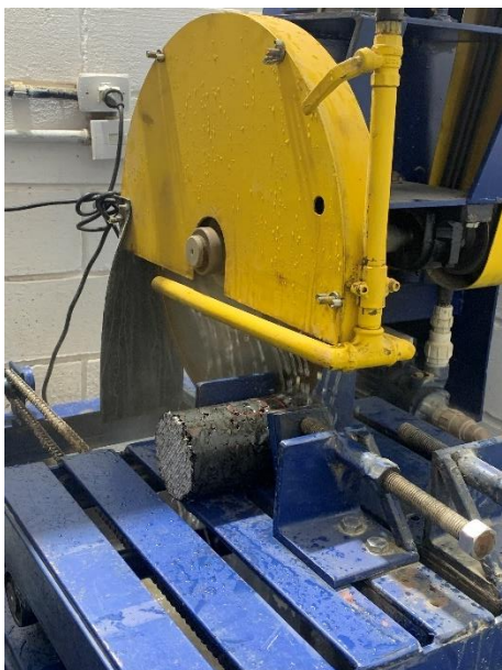
Figura 23 - Algumas das atividades acompanhadas pelos bolsistas no Setor de Ensaios Especiais: (a) serragem de corpos de prova e (b) ensaio de resistência à tração por compressão diametral
