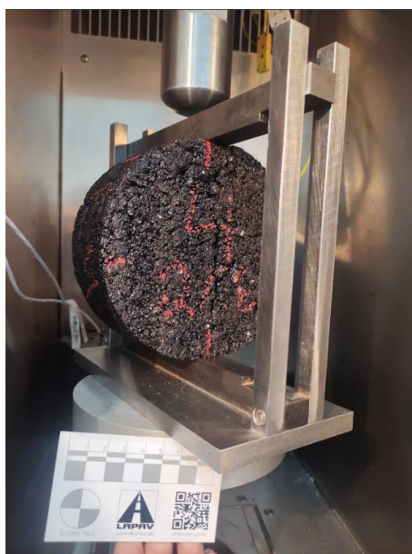
Figura 102 – Atividades acompanhadas pelos bolsistas no Setor de Ensaio Dinâmico: (a) módulo de resiliência na compressão diametral e (b) fadiga na tração por compressão diametral
