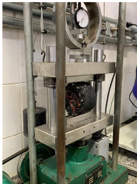
Figura 23 - Algumas das atividades acompanhadas pelos bolsistas no Setor de Ensaios Especiais: (a) serragem de corpos de prova e (b) ensaio de resistência à tração por compressão diametral
