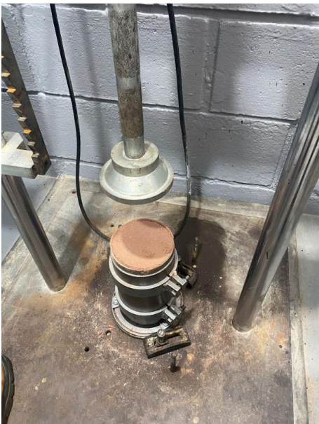
Figura 101 – Atividades desenvolvidas pelos bolsistas no Setor de Ensaio Dinâmicos: (a) compactação vibratória de amostras e (b) ensaio triaxial de módulo de resiliência (15x30 cm)
