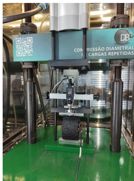
Figura 102 – Atividades acompanhadas pelos bolsistas no Setor de Ensaio Dinâmico: (a) módulo de resiliência na compressão diametral e (b) fadiga na tração por compressão diametral
