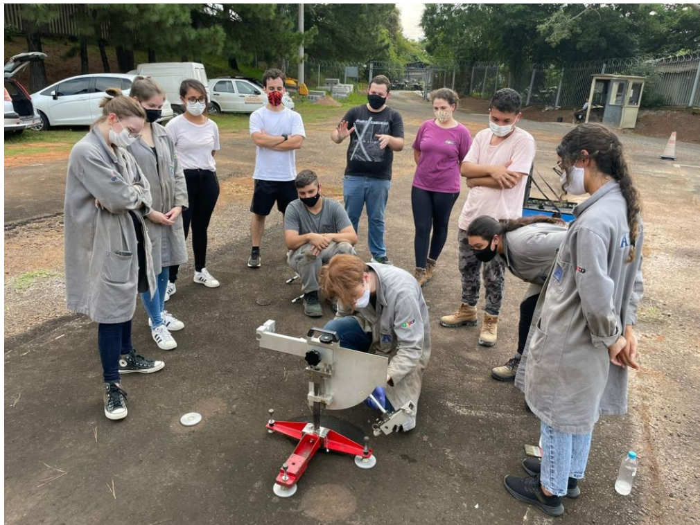
Figura 25 - Treinamento para realização de ensaios de campo para determinação da microtextura (Ensaio do Pêndulo Britânico)
