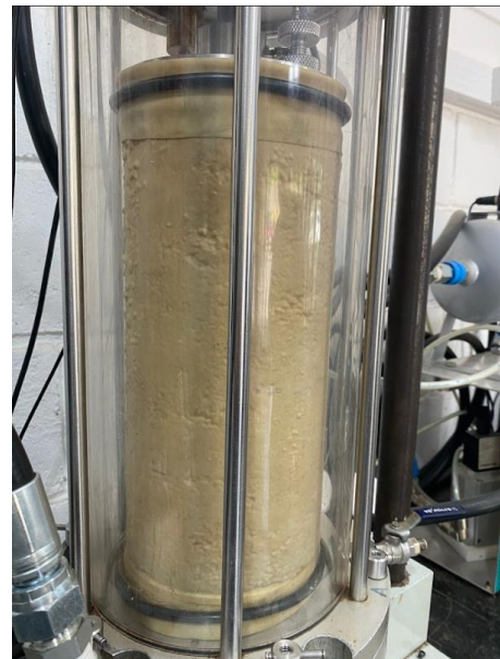
Figura 101 – Atividades desenvolvidas pelos bolsistas no Setor de Ensaio Dinâmicos: (a) compactação vibratória de amostras e (b) ensaio triaxial de módulo de resiliência (15x30 cm)
