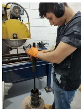
Figura 3. Moldagem dos CPs pela compactação dinâmica
