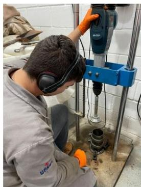
Figura 2. Moldagem dos CPs no compactador vibratório
