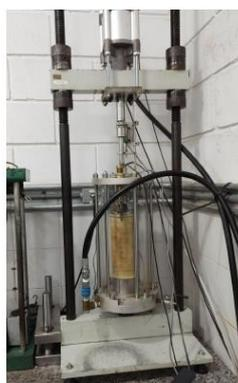
Figura 6. Equipamento ensaio de MR Triaxial
