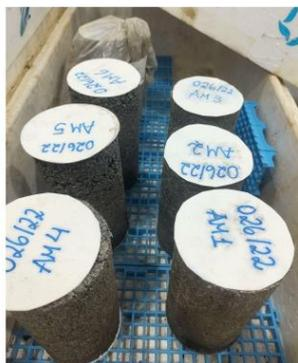
Figura 5. Corpos de prova na câmara úmida
