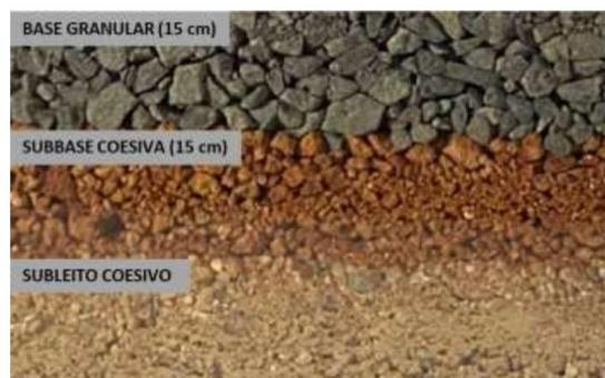
**Figura 5:** Estrutura-tipo do pavimento analisado
