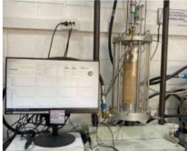
**Figura 2:** Ensaio Triaxial de Cargas Repetidas em andamento
