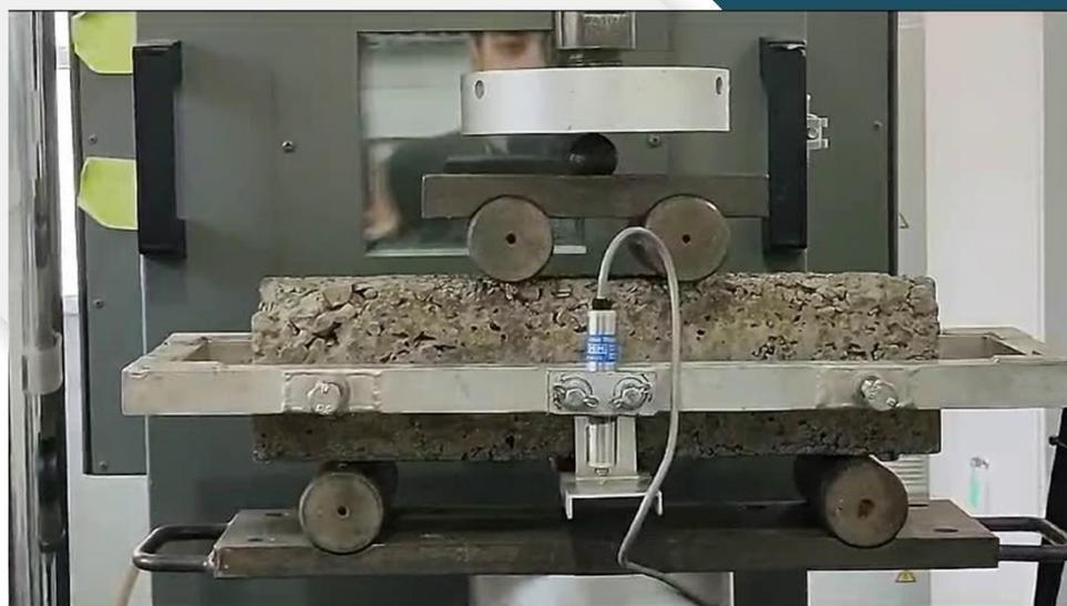
Carga aplicada: 2,3kN/min
